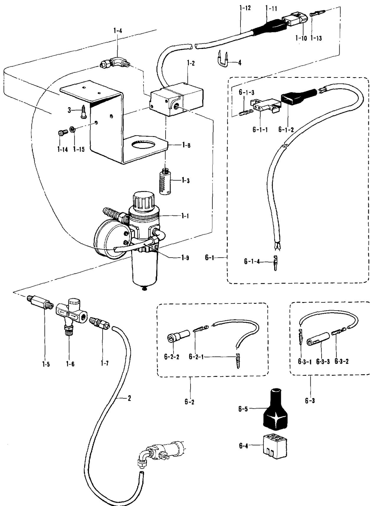
V. 空圧関係 / Air pressure mechanism / Luftdruck /
