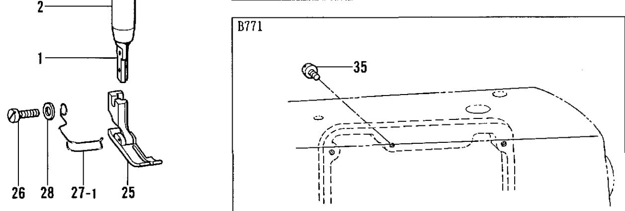
E. 押工関係 / Presser foot mechanism / Stoffdrückerfuß /
