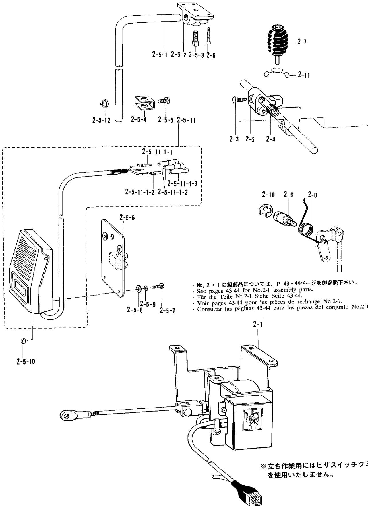
**W2. 電磁押工上げ関係 / Presser foot lifting solenoid set / Solenoidsatz für die Anhebung des Stoffdrückerfußes /
