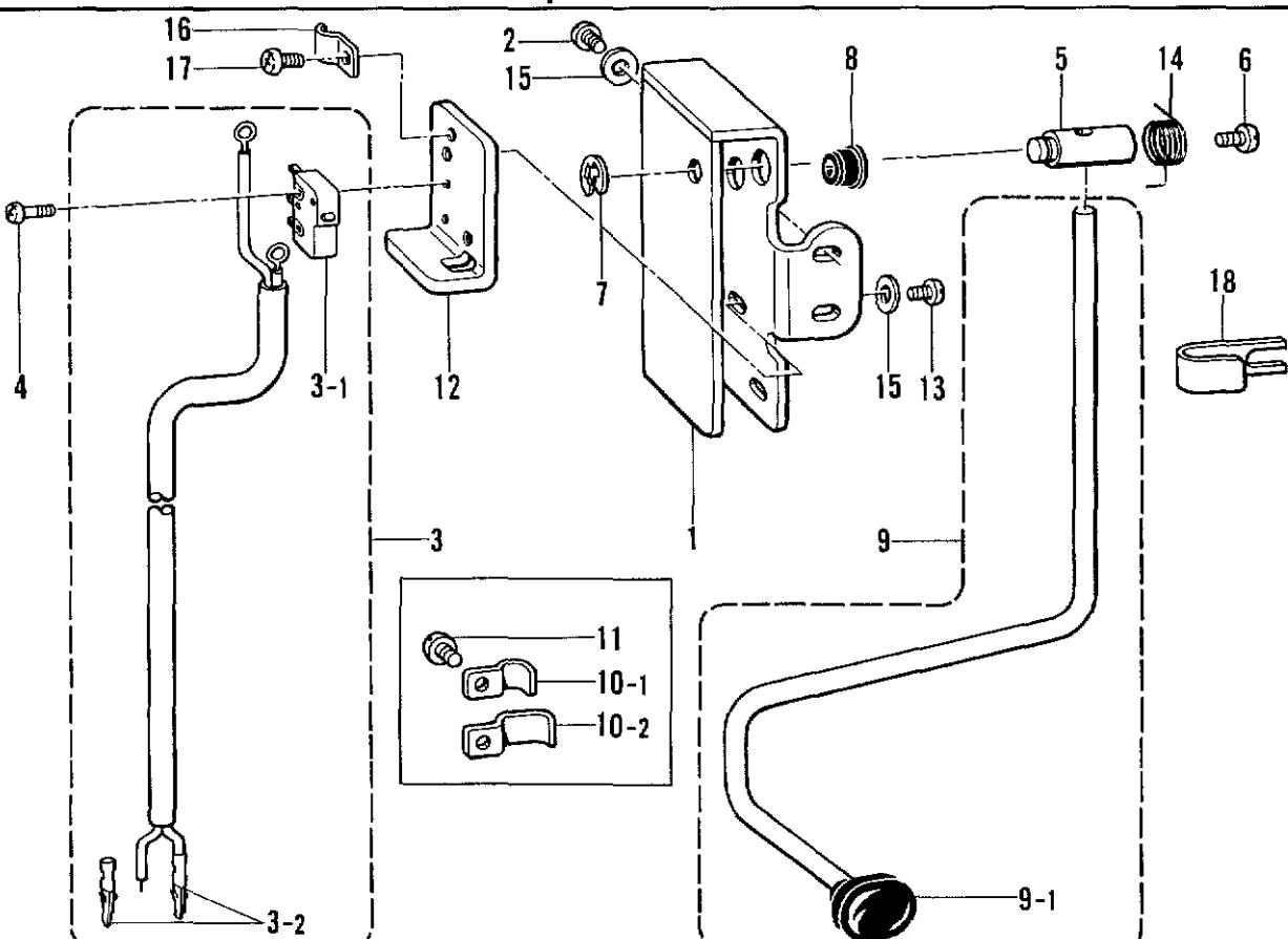
T. ヒザスイッチ関係 <B772> / Knee switch mechanism <B772> / Knieschalter <B772> /
