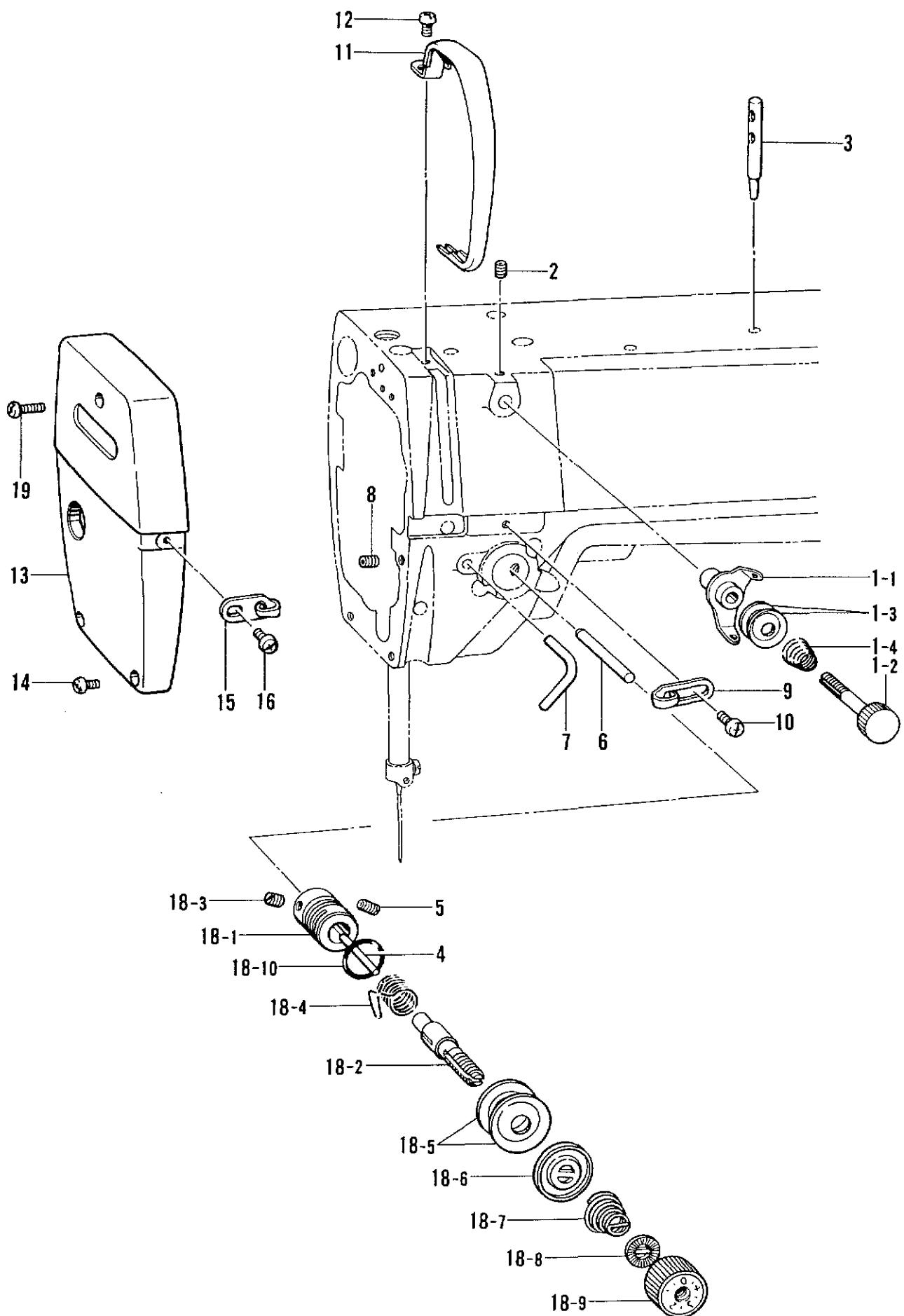
L1. 糸通シ関係 <B772> / Threading mechanism <B772> / Fadenführungs vorrichtung <B772> /
