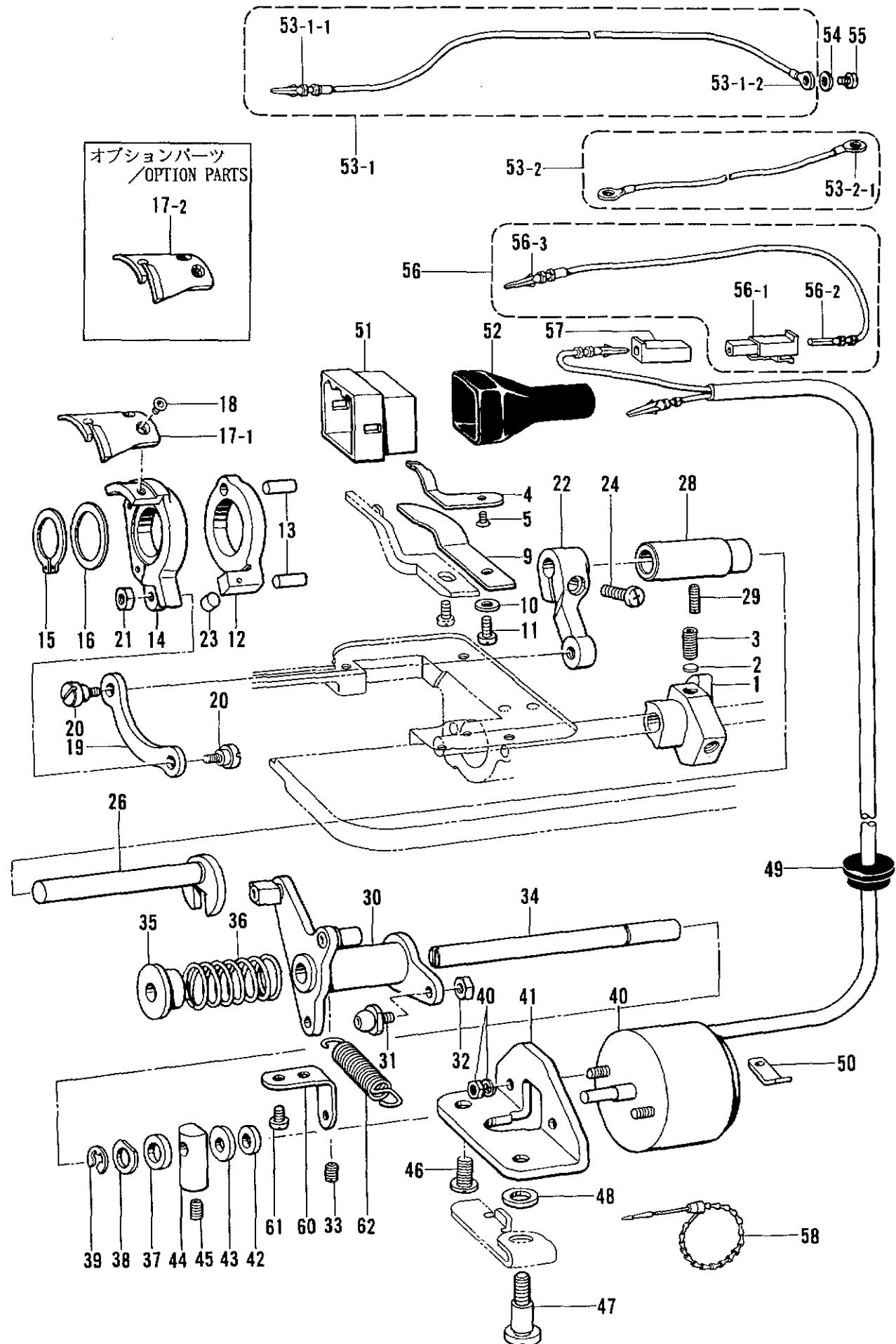
N. 糸切り関係 <B772> / Thread trimmer mechanism <B772> / Fadenabschneidevorrichtung <B772> /
