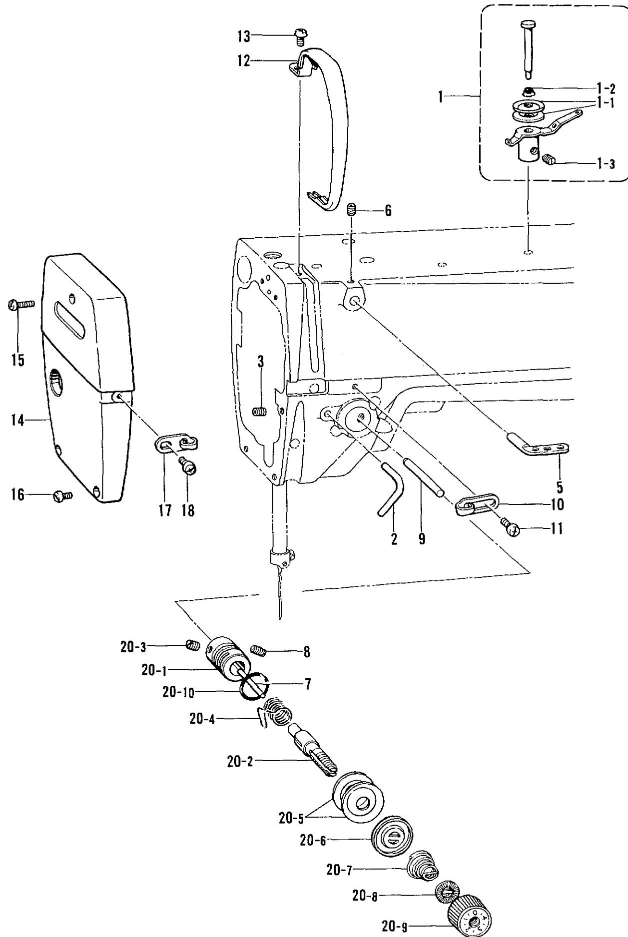
L2. 糸通シ関係 <B771> / Threading mechanism <B771> / Fadenführungs vorrichtung <B771> /
