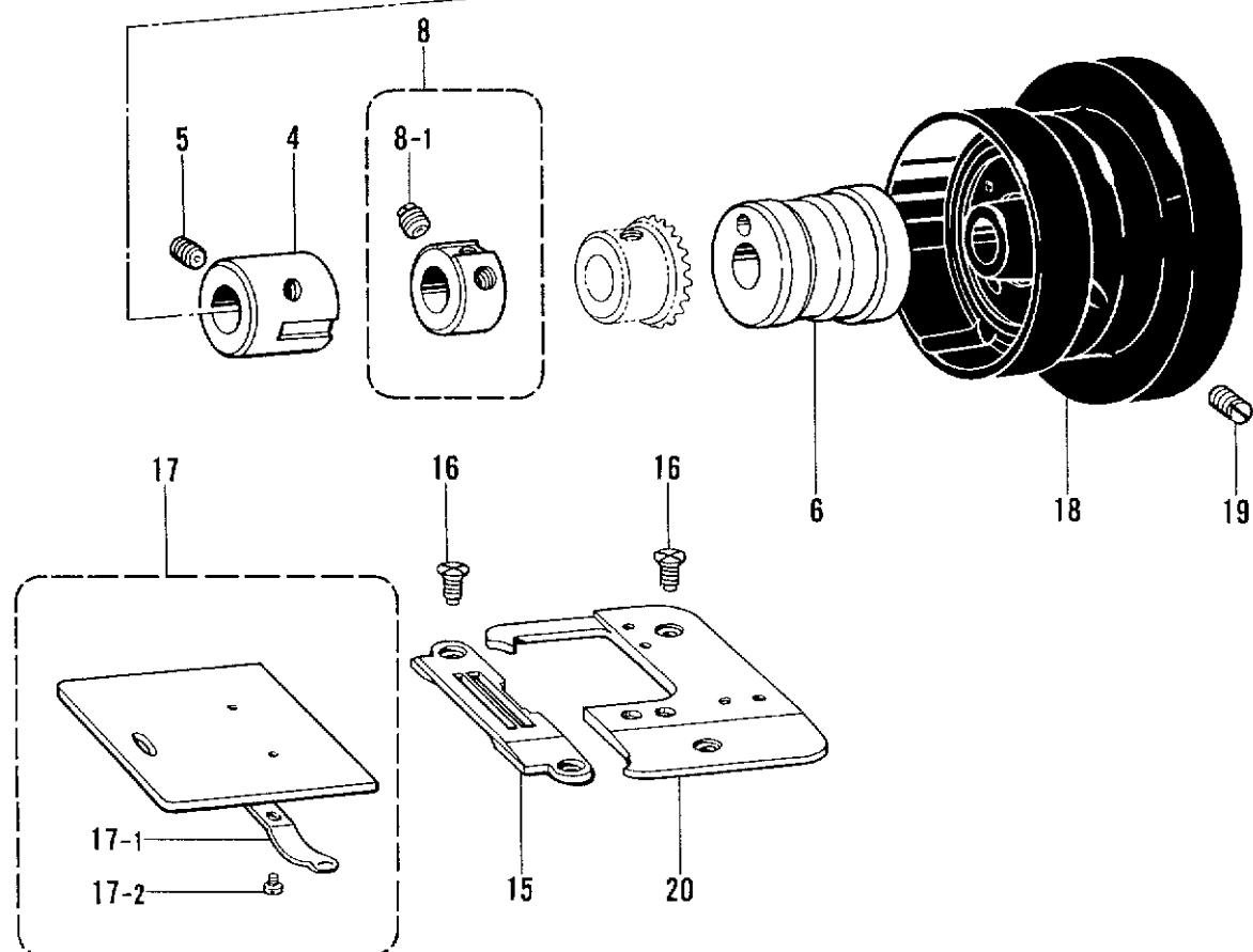
C. 上軸天ビン関係 / Upper shaft and thread take-up mechanism / Obere Welle und Fadenabnahmeverrichtung /
