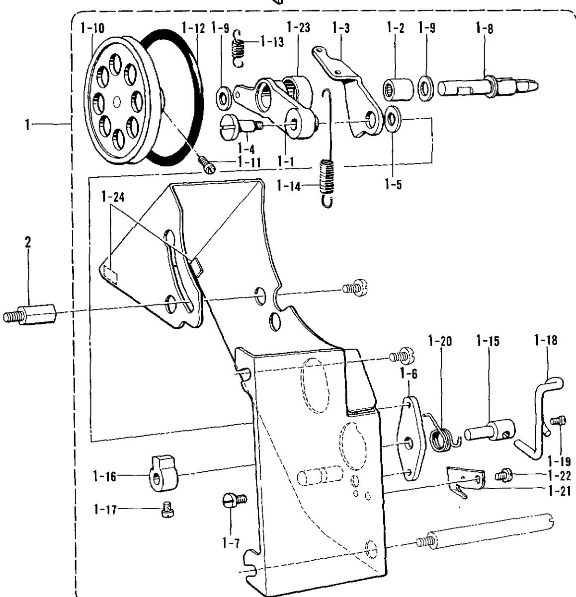
M. 糸巻キ関係 <B772> / Bobbin winder mechanism <B772> / Spuler <B772> /
