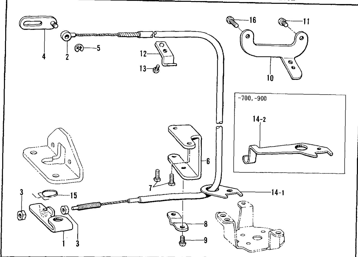
Q. 糸拭イ関係 <B772> / Thread wiper mechanism <B772> / Fadenwischvorrichtung <B772> /
