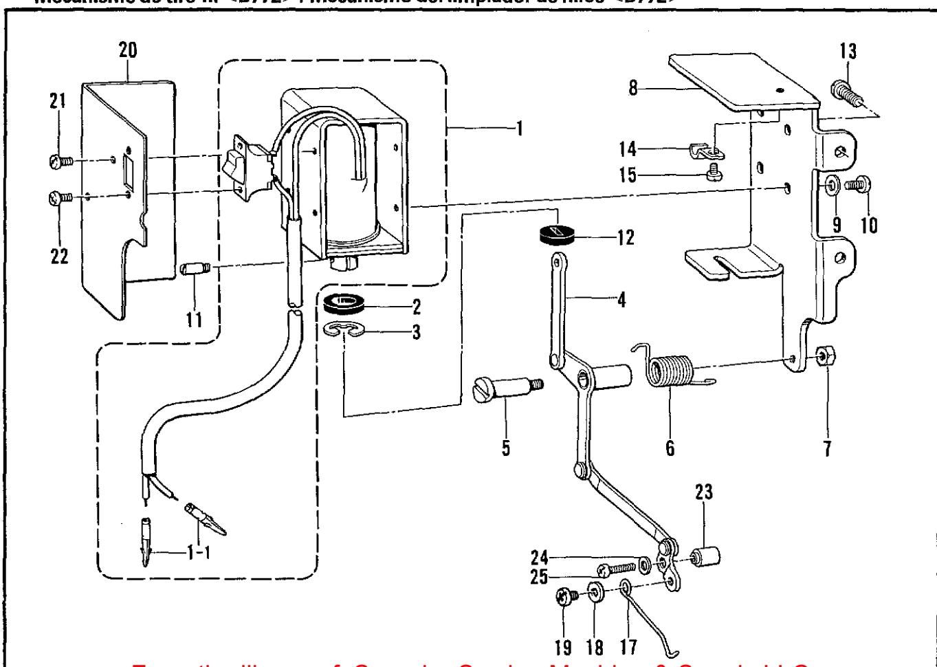
P. 糸ユルメ関係 <B772> / Tension release mechanism <B772> / Spannungsverminderungsvorrichtung <B772> /
