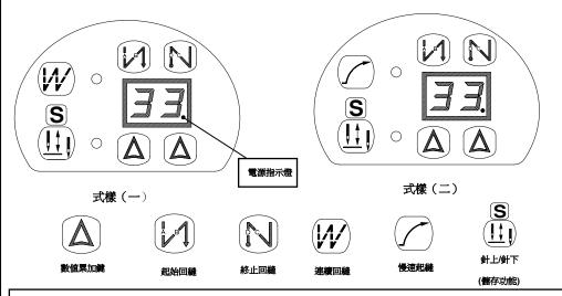
終止回縫設定:接 $\bigcirc$  **費**顯示板右側出現數字時,再按右側 $\bigcirc$  可調整  $0\sim F(1\sim 15)$ 針數,取消時無顯示。
