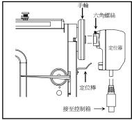
將定位器安裝於手輪心軸突出處並將定位器底 部凹槽對準車頭上的定位棒,位置調好後將定 位器轉子上的兩顆六角螺絲鎖好,最後將定位
